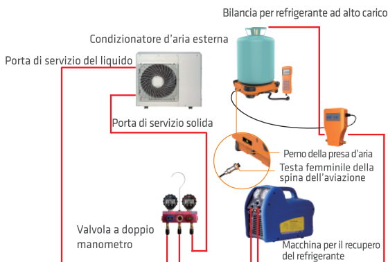
Diagramma di recupero del refrigerante
